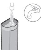
**4** Rincez le réservoir d'eau. Remplissez le réservoir d'eau claire et replacez-le dans la machine.
