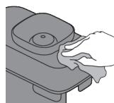
Reinigen Sie das Innere des Kaffeebohnenbehälters und das Äußere der Maschine mit einem feuchten Tuch.
