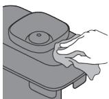
Nettoyer l'intérieur du bac à grains et l'extérieur de la machine à l'aide d'un chiffon humide.
